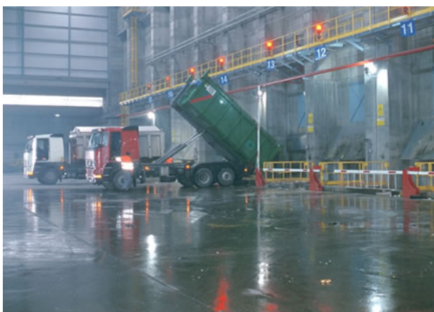
Scarico dei rifiuti nella vasca di stoccaggio
