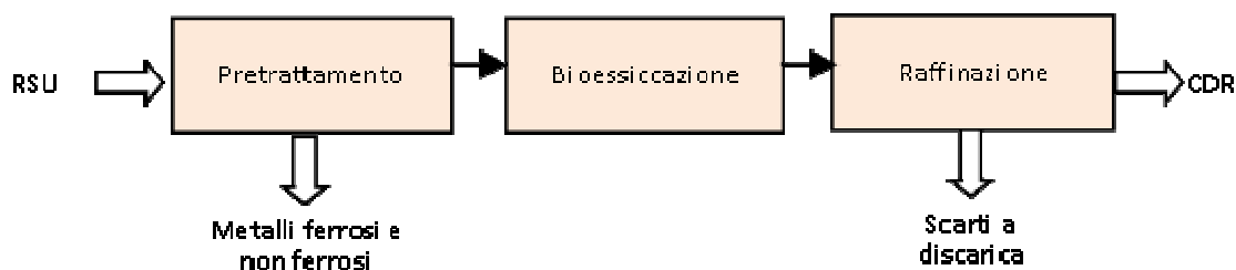
Fig. 21 - Schema del processo Nehlsen.
