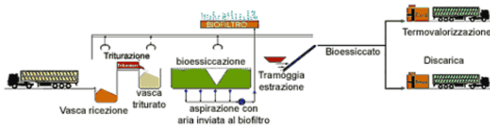
Fig. 6.2 – Rappresentazione schematica del processo Biocubi Ecocodeco [88]
