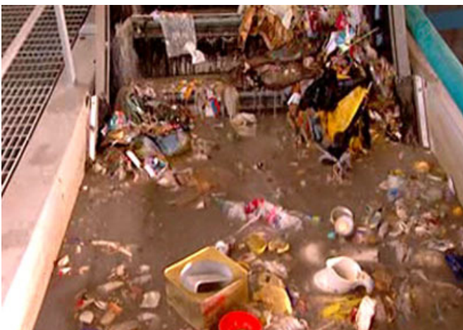
Fig. 6.11 - Sezione di separazione idro-meccanica e digestione anaerobica nell'impianto Arrow Bio [52]
