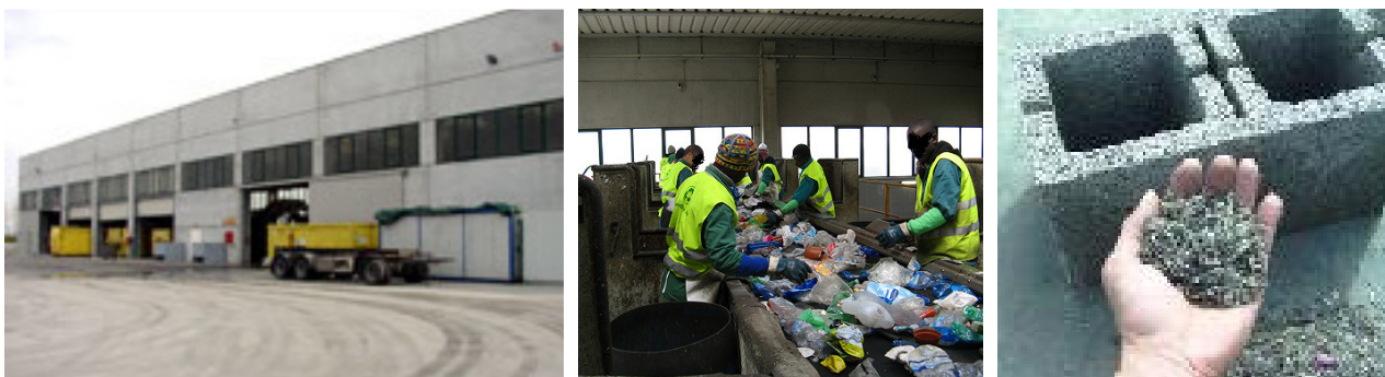
Fig. 39 - Centro Riciclo Vedelago: vista dell'impianto (a sinistra), selezione manuale (al centro), sabbia sintetica (a destra) [19].
