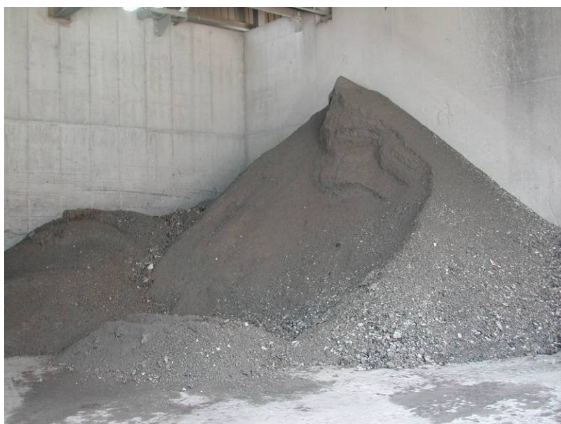
Fig. 1.5 - Ceneri di fondo da termovalorizzazione di rifiuti solidi urbani
