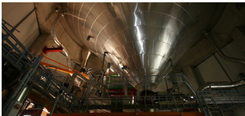
Fig. 3.8 – Schema tipico dei reattori operanti secondo tecnologia Dranco (a sinistra); Digestore di Wijster, Netherlands, il più grande digestore Dranco al mondo (a destra).
