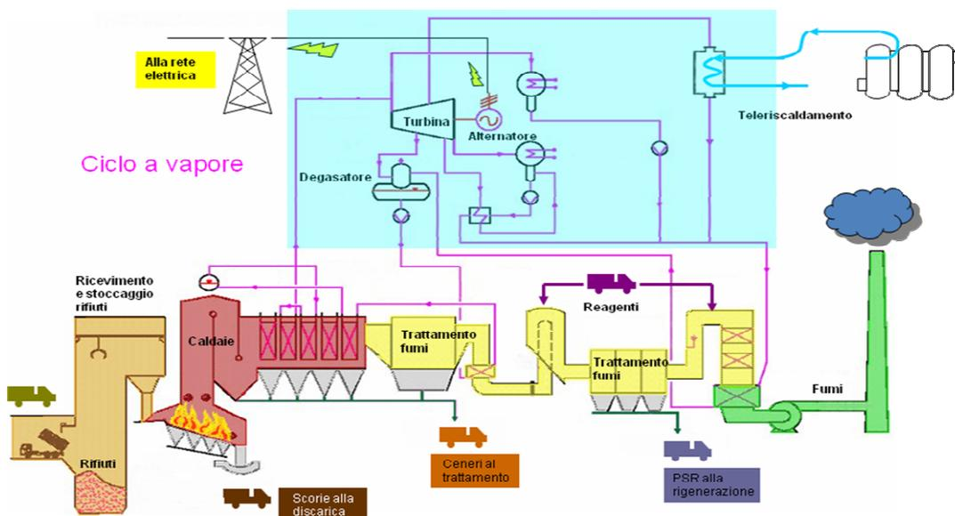
Fig. 1.1 - Termovalorizzatore del Gerbido: schema di principio [46]
