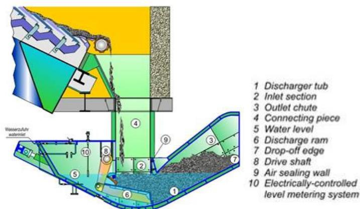
Fig. 1.3 – Sistema di estrazione e raffreddamento scorie [46]
