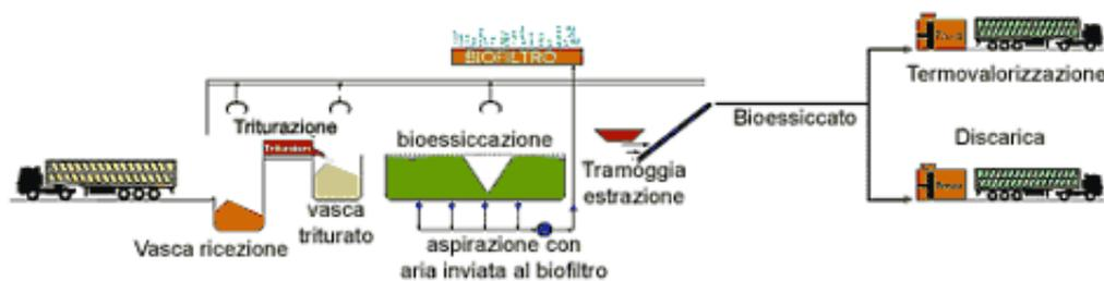
Fig. 6.2 – Rappresentazione schematica del processo *Biocubi* Ecodeco
