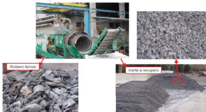
Fig. 3-4- Processo fisico-meccanico basato sulla separazione mediante vagliatura e deferrizzazione
