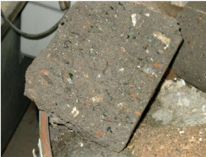
Fig. 3-6- CIC-conglomerato idraulico catalizzato
