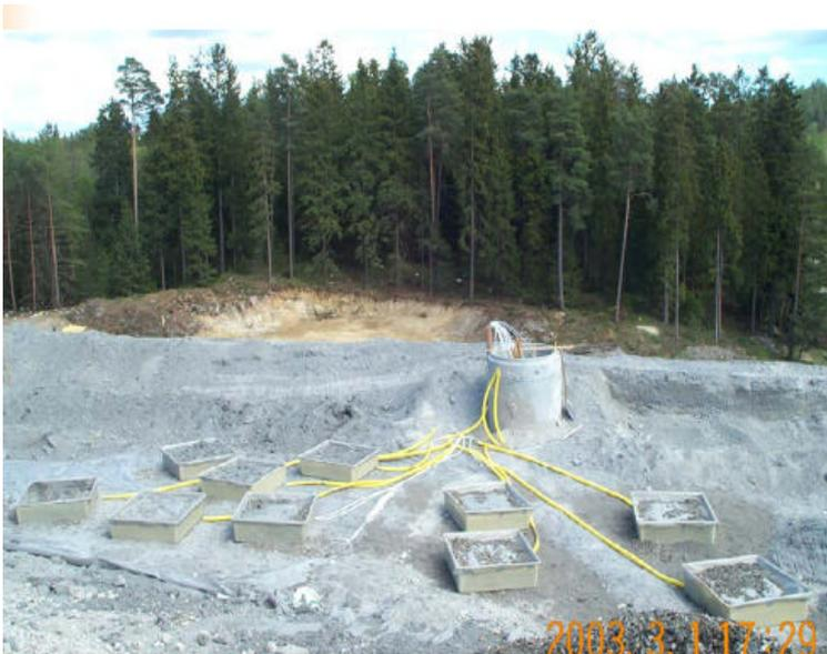
Fig. 4-4 - Tveta Landfill: lisimetri installati nel campo prove.
